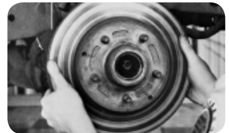
Replace drum or rotor (fig. 11).
