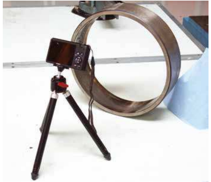
Fig. 12 : Un appareil-photo compact installé sur un trépied est généralement suffisant pour prendre des photos de qualité acceptable de roulements endommagés.
