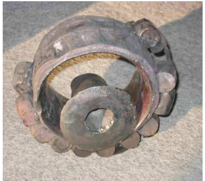
Fig. 2 : Roulement trop sévèrement endommagé pour réaliser le diagnostic de la cause probable de la défaillance. L'élément au centre est ce qui reste de l'arbre qui supportait le roulement.
