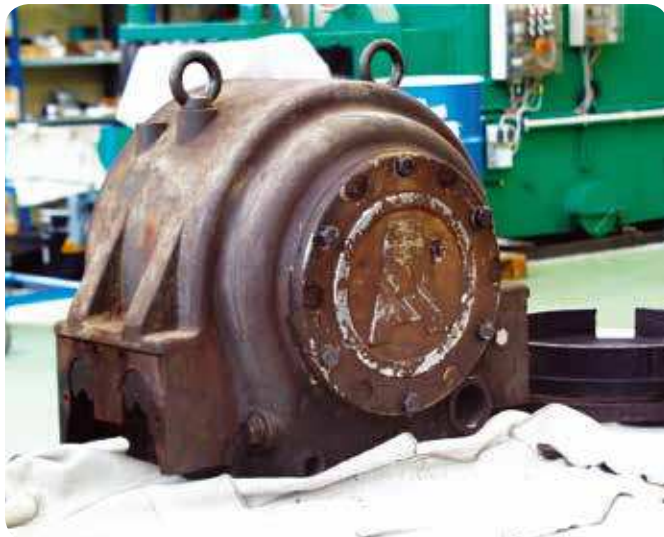
Fig. 13 : Palier sur couteaux avant modification
