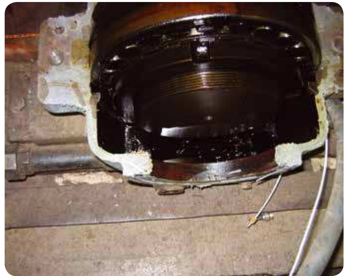
Fig. 9 : Palier boulonné sur le bâti avec compensation du déplacement axial par le roulement libre dans son logement
