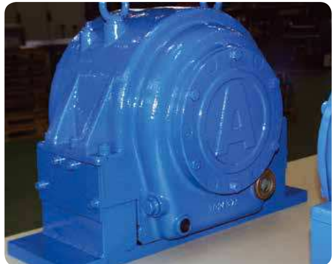
Fig. 14 : Palier sur couteaux converti en palier fixe par SKF
