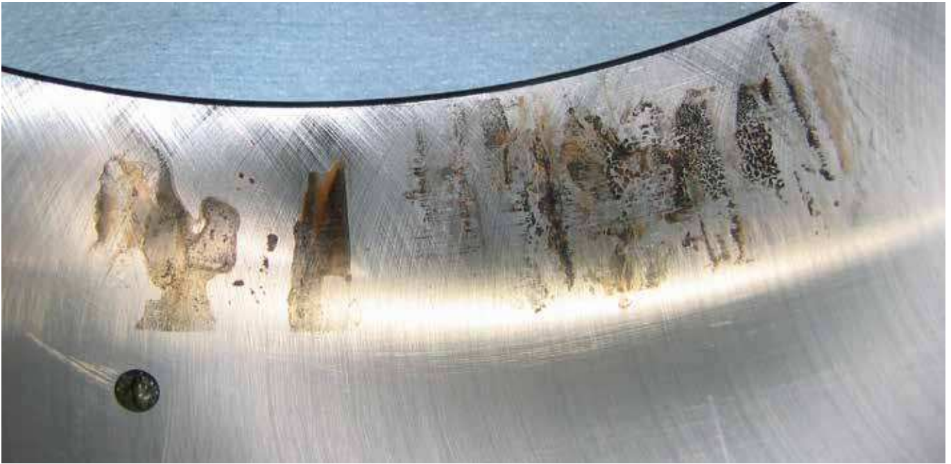
Corrosion sur un roulement à l'arrêt due à la contamination de la graisse par l'eau de process.
