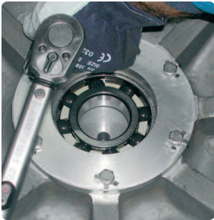
安装于低温泵壳的SKF轴承解决方案
