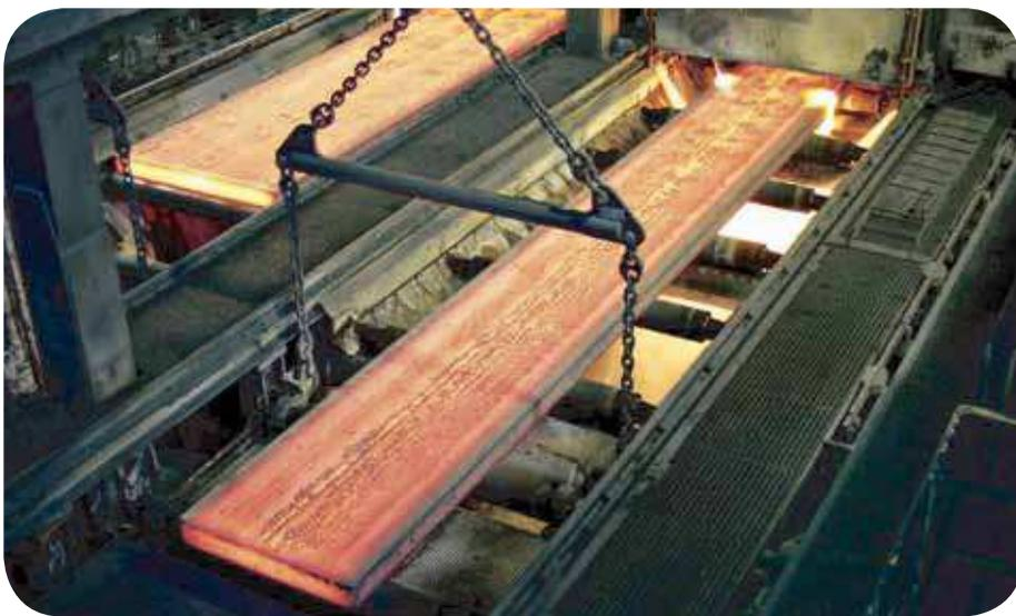
新辊系带来的额外好处是设备定期的停机维护次数也得到减少。在改造之前，该钢厂大约每六个星期便要停机一次。使用SKF ConRo辊系单元之后，可以做到每十个月停机维护一次。更不必说明显减少的非计划事故停机次数。
