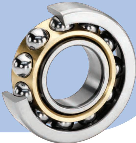
SKF Explorer 探索者单列角接触球轴承可同时应付径向和轴向负荷，其特色是，这类轴承可在较冷和较平稳的条件下运行，从而能降低润滑剂消耗，将轴承的使用寿命增加到 300%。
