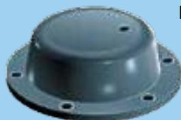
Diseñado para los sistemas actuales lubricados con grasa, el tapacubos Scotseal TF hermético cuenta con una válvula patentada tipo "paraguas" que evita el ingreso de contaminación y ventila la presión interna para que se mantenga a niveles tan bajos como 2 psi. La incorporación de una placa antisalpicaduras al diseño del tapacubos ayuda a proteger contra las condiciones adversas creadas por los fragmentos de los caminos, los lavados a presión y los muelles inundados.
