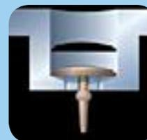
La válvula tipo "paraguas" ventea la presión, incluso cuando está cubierta con 1/4 in de grasa; la placa antisalpicaduras ofrece protección adicional contra los lavados a presión
