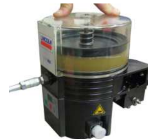
Befüllen des Behälters Abb. 19
