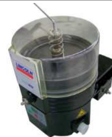
Behälter wieder montiert Abb. 18
