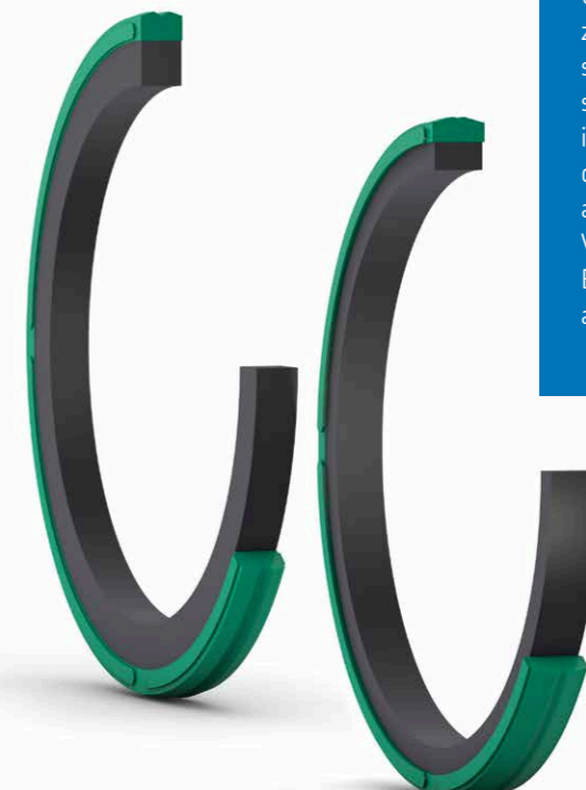
Für moderat bis hoch beanspruchte Anwendungsfälle erste Wahl: Die neuen Kolbendichtungen aus X-ECOPUR PS von SKF; links für Hydraulikzylinder mit metrischen Abmessungen (MPV), rechts für solche mit Zoll-Abmessungen (DPV).
