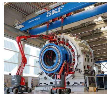
Im neuen Sven Wingquist Test Center in Schweinfurt werden kommende Großlager-Generationen geprüft und optimiert.
