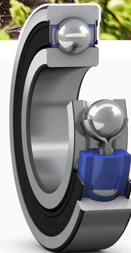
Wie ein Schwamm: Die Polymermatrix der MTRX-Lager von SKF füllt fast den gesamten freien Raum innerhalb eines Lagers aus, enthält etwa zwei- bis viermal mehr Öl als herkömmliche fettgeschmierte Lager, bildet dadurch einen regelrechten Schutzschild für die einzelnen Lager-Komponenten und sorgt im Endeffekt für eine längere Lebensdauer – selbst unter härtesten Einsatzbedingungen.
