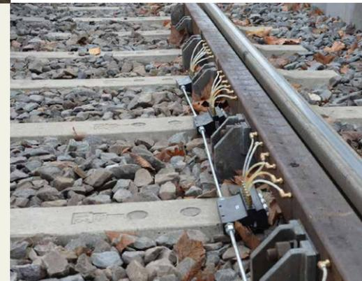
Auf der InnoTrans zeigte SKF spezielle Schmierungslösungen wie die verschleiß- und geräuschkindernde Schienen-Schmieranlage SL oder das ressourcenschonende Spurkranzschmiersystem EasyRail Airless.
