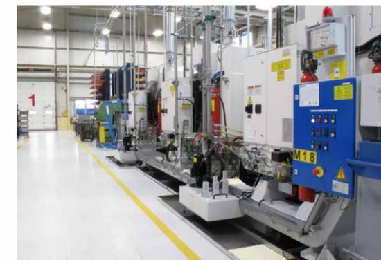
Die Hebepumpen im Späneförderer transportieren das grob vorgereinigte Kühlschmiermittel zur Filteranlage.
