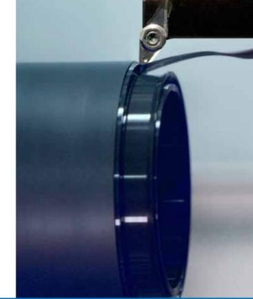
Faltenbalg mit Dichtrillen und Spannbund aus ECOPUR\_95A-bIFG.
