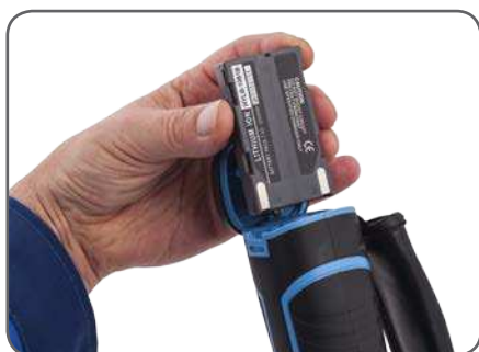
Einsetzen der Batterie
