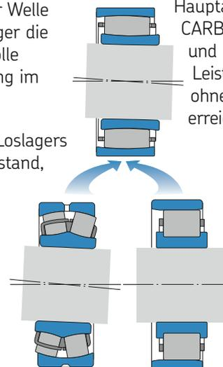
Und genauso wie Zylinderrollenlager können sie axiale Verschiebungen aufnehmen.
