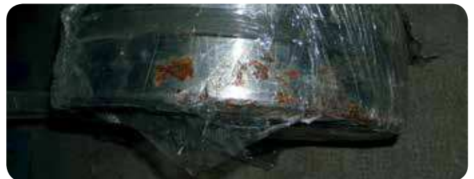
Fig. 3 Roulement stocké, corrodé par l'humidité.
