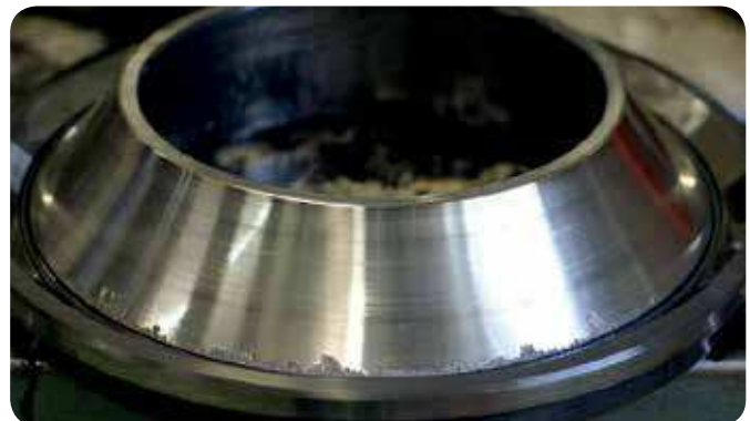
Fig. 2 Roulement en acier amélioré présentant un écaillage
