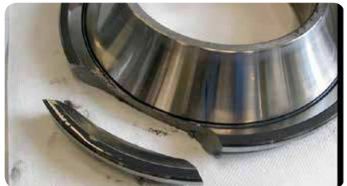
Fig. 2 Roulement en acier amélioré présentant un écaillage
