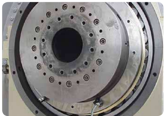
Fig. 9 Le comparateur à cadran caché par le tourillon sur la fig. 8.
