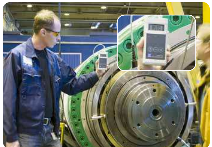
Fig. 5 0,50 : le serrage requis est atteint et la pompe hydropneumatique est arrêtée.
