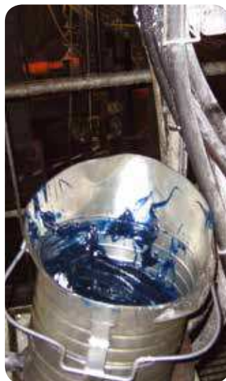
Photos 3 et 4 – Bouteille en plastique découpée utilisée pour transvaser la graisse de son fût d'origine dans un bac utilisé pour la relubrification des roulements ouverts
