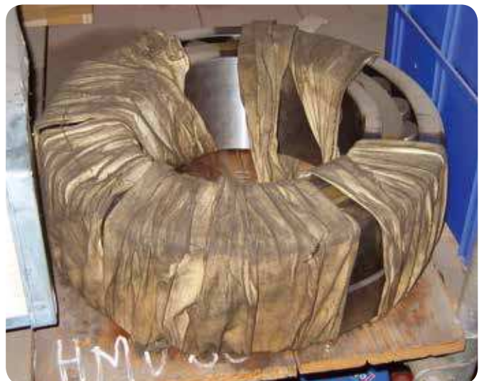
Photo 5 – Roulement stocké sans protection contre la poussière
