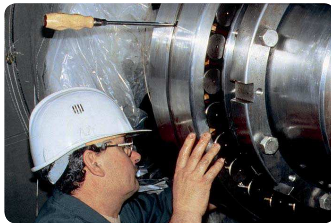
Fig. 7. Rotation de la bague extérieure avec un tournevis propre.
