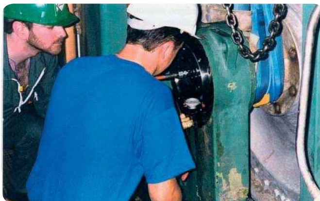
Fig. 2. Le premier CARB™ monté en France à l'usine International Paper Saillat selon la méthode par enfoncement axial SKF. L'auteur est à gauche sur la photo.
