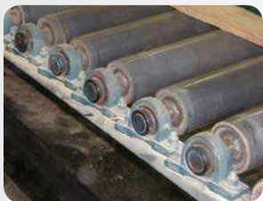
Superaquecimento de rolamento de esteira rolante
