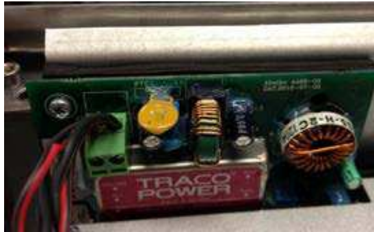
Рисунок 2 - 1. Клеммы источника питания 24 В пост. Тока.
