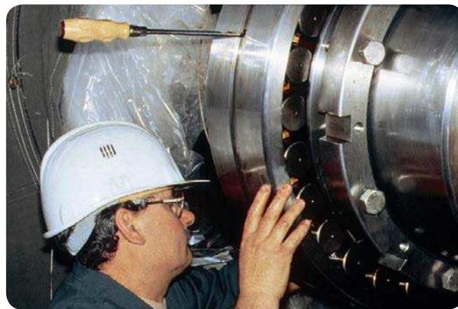
Fig. 7. Girando el aro exterior con un destornillador limpio.
