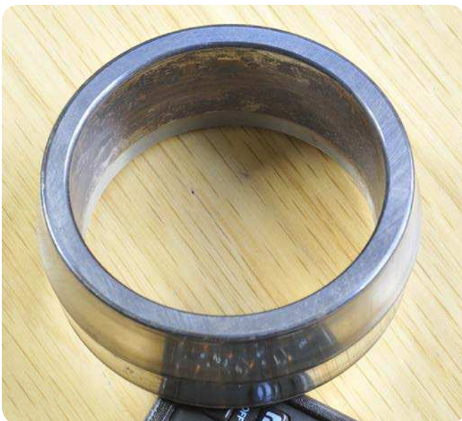
Fig. 1. Aro interior de un rodamiento de rodillos a rótula que presenta corrosión por contacto en el agujero debido a un ajuste insuficientemente apretado.
