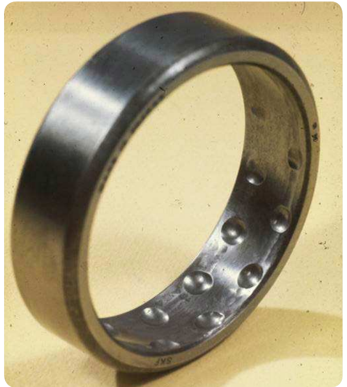
Fig. 4 Un aro exterior de un rodamiento de bolas a rótula que ha sido sometido a vibrocorrosión.
