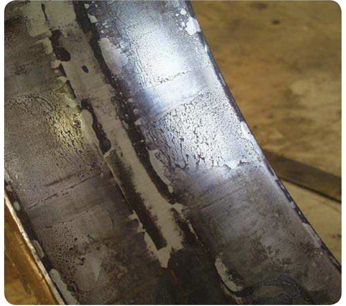
Fig. 3 El aro exterior de un rodamiento de rodillos a rótula que estaba montado en una máquina papelera.
