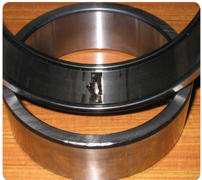
Fig. 2 Corrosión por inactividad en un rodamiento de agujas de una planta de transformación de tisé. La máquina en la que estaba montado se había limpiado con agua a alta presión.
