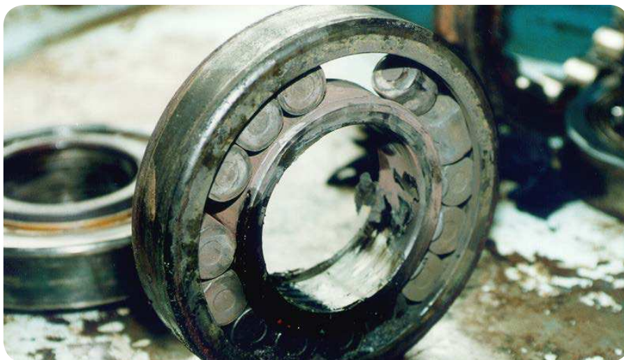
Ett exempel på ett totalhavererat cylindriskt rullager med hållarblockage. Denna typ av skada går ej att analysera.
