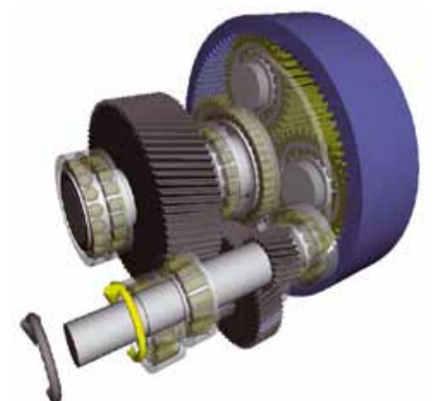
Beräkningar och simuleringar utförs med program som utvecklats av SKF och är specialiserade på att hantera rullningslagrets specifika icke-linjära egenskaper. Metoderna baseras på FEM-teknik och på de senaste rönerna inom Multi-body-simuleringar.
