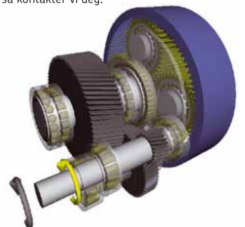
Beregninger og simuleringer utføres ved hjelp av programmer som er spesielt utviklet av SKF for å håndtere rullelagrenes spesifikke ikke-lineære egenskaper. Metodene er basert på FEM-teknologi og det aller nyeste innenfor såkalte multi-body-simuleringer.
