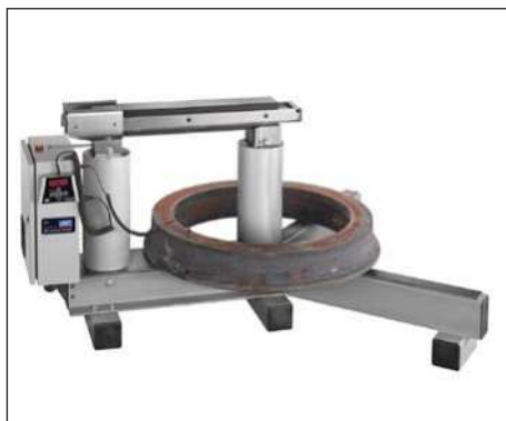
Figur 5: TIH L med opvarmning af vandret emne
