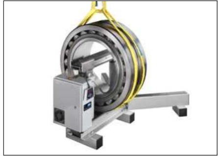
Figure 4: TIH L avec chauffage de pièce verticale
