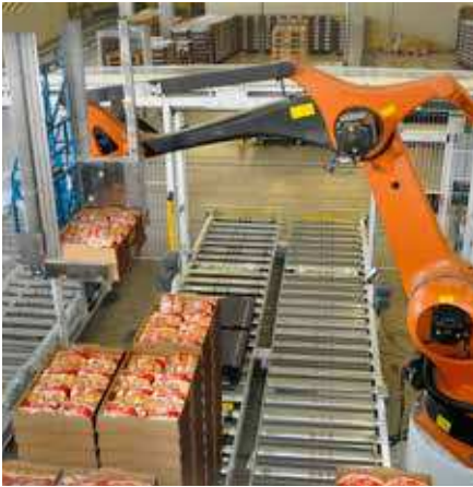
Pågen är ett modernt bageri med högt ställda krav. Här packas bröd automatiserat enligt butikernas beställningar med hjälp av robotar.
