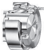
7. ábra Lehúzó hüvely kihúzása HMV anyával
