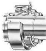
8. ábra Szorító hüvely meglazítása HMV anyával és külön támasztó tárcsával.
