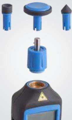
Он поставляется с тремя контактными переходниками для измерения угловой и окружной скорости контактным способом.
