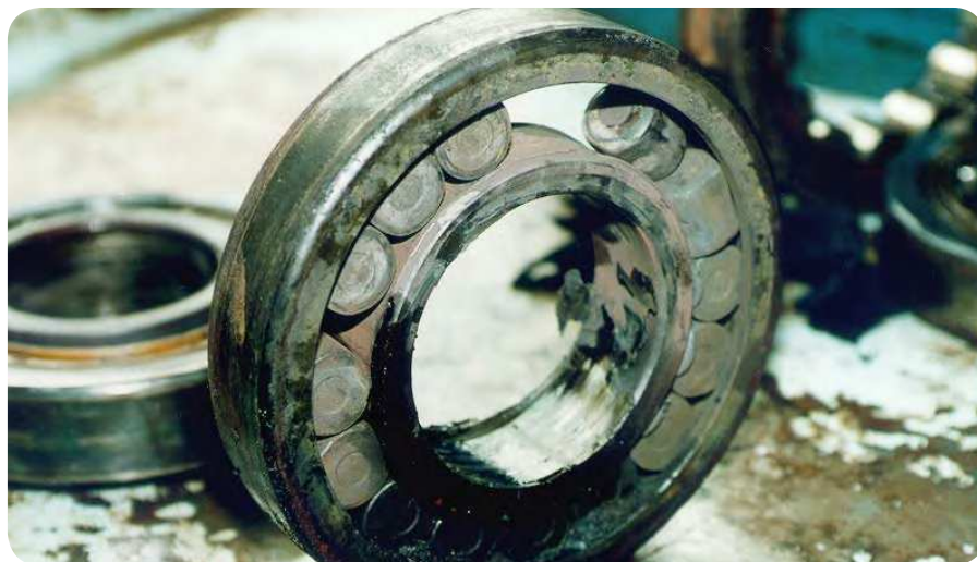
Et eksempel på et totalhavareret cylindrisk rulleleje med holderblokering. Denne type skade kan ikke analyseres.
