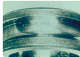
Vaihe 2: Pinta vahingoittuu ja pieniä säröjä muodostuu. Mikrokuoriutuma alkaa.
