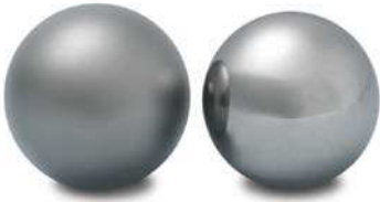
Auswirkungen von Mikrokratern aufgrund von Erosion durch hochfrequente Kriechströme. Vergleich zwischen einer Kugel mit (links) und ohne (rechts) Mikrokrater
