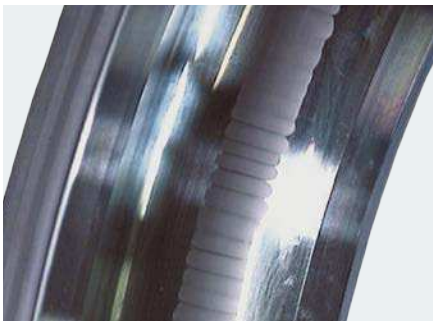
Riffel an den Laufflächen sind Sekundärschäden, die in der Regel durch elektrische Ströme verursacht werden, die durch das Lager fließen.
