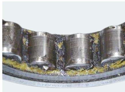
Außenring eines Zylinderrollenlagers mit Käfig, Rollen und Schmierfett: Verbranntes Schmierfett (schwarz) an Käfigstegen infolge von Kriechströmen
