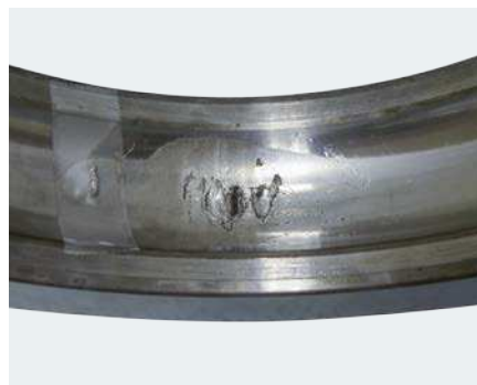
Kugellager-Laufbahn mit starken Ausbrüchen aufgrund von Elektroerosion
