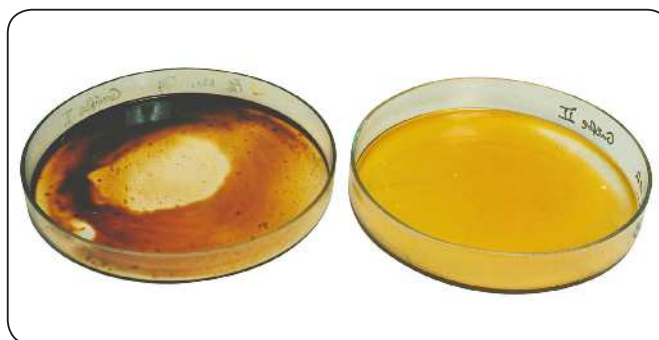
Fig. 8 Essai SKF de vieillissement de l'huile. À gauche, après quatre semaines d'utilisation à 140 °C, l'huile synthétique s'est résiniifiée et la perte, par évaporation, s'élève à 93%. À droite, après 4 semaines d'utilisation à 120 °C, la perte par évaporation de l'huile minérale est de 2 % seulement.
