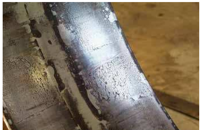
Fig. 3 Bague extérieure d'un roulement à rotule sur rouleaux monté sur une machine à papier.
