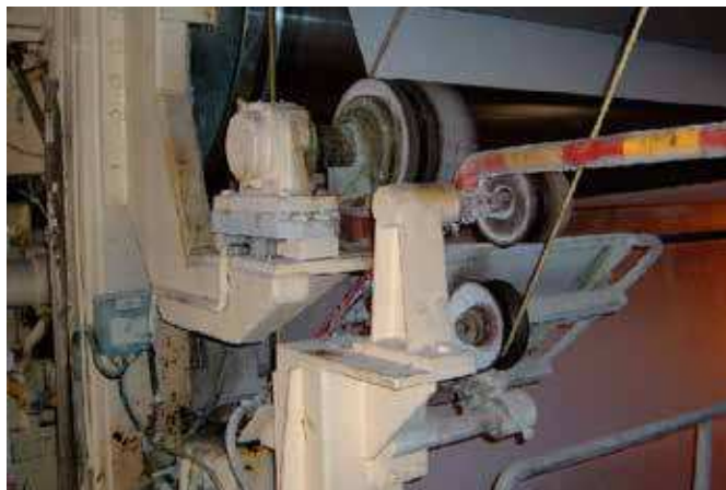
Fig. 7 La poussière s'accumule sur les arbres et moyeux.
