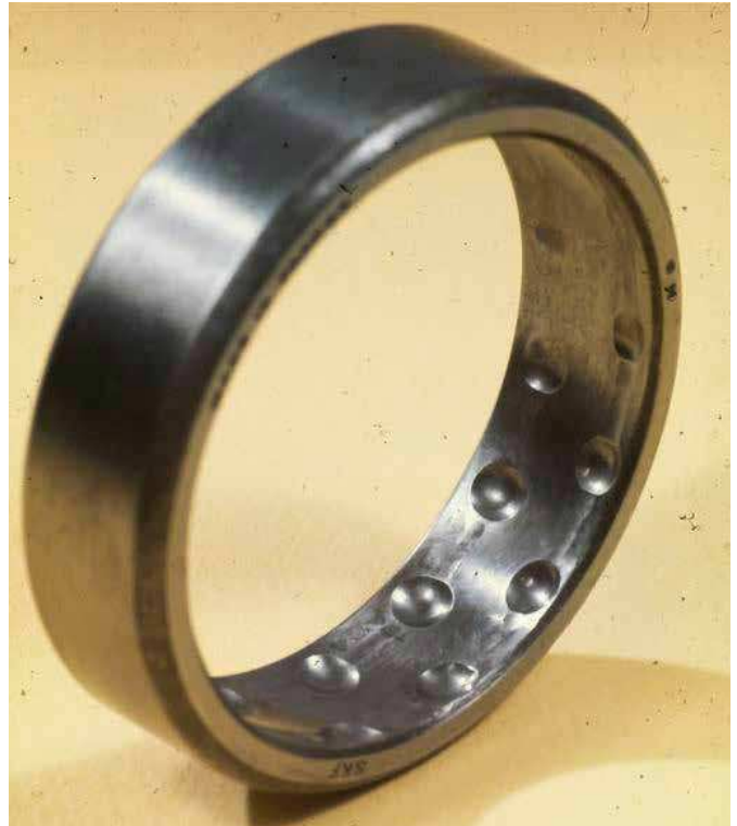
Fig. 4 Bague extérieure d'un roulement à rotule sur billes exposé à un faux effet Brinell.
