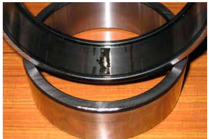
Fig. 2 Corrosion à l'arrêt dans un roulement à aiguilles utilisé dans une usine de transformation de ouate. La machine sur laquelle il était monté avait été nettoyée à haute pression.
