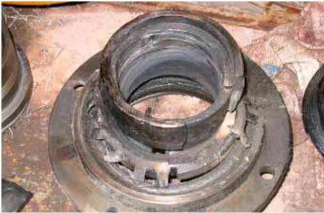
Fig. 12 : Usure avancée due à la rotation sur l'arbre du manchon de serrage d'un roulement de rouleau de feutre de sécherie. Du fait de la température élevée, le jeu du roulement a diminué, ce qui s'est traduit par une précharge incontrôlée et, au final, un grippage.
