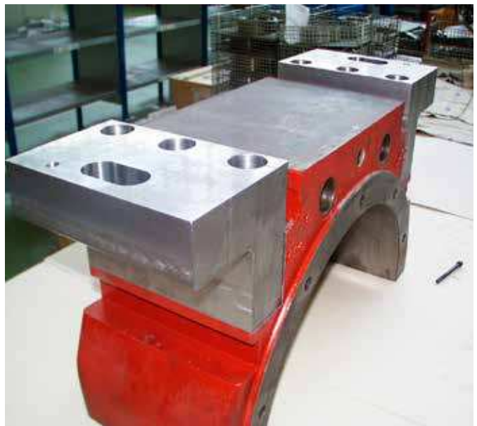
Fig. 5 : La semelle du palier est usinée pour supprimer les couteaux et adapter des pieds sur mesure. Les orifices d'entrée et d'évacuation de l'huile sont également modifiés.
