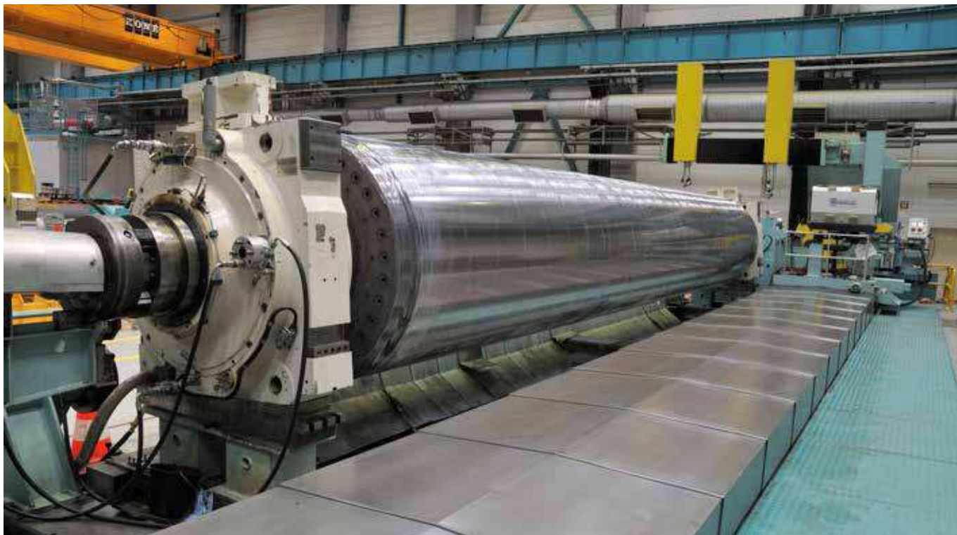
Fig. 7 : Rectifieuse de rouleaux équipée du rouleau tournant sur ses roulements principaux.
