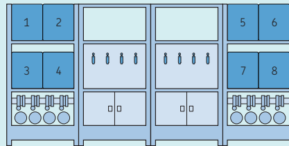
N.º do modelo: SU5 – até oito carretéis de mangueira 8 x 246 litros (8 x 65 US gal)
