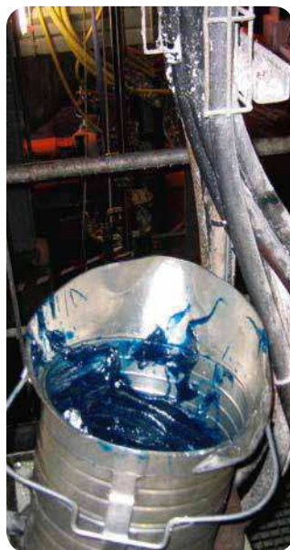
Fig. 3 e 4 Uma garrafa de plástico cortada embaixo usada para transferir graxa do seu tambor original para um recipiente que é utilizado para lubrificar rolamentos abertos.
