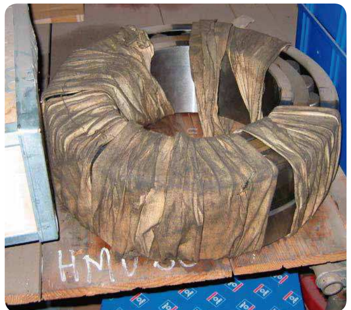
Fig. 5 Rolamento armazenado sem proteção contra poeira.
