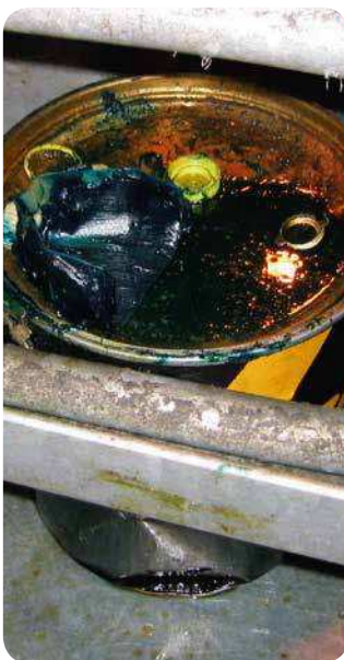
Fig. 3 e 4 Uma garrafa de plástico cortada embaixo usada para transferir graxa do seu tambor original para um recipiente que é utilizado para lubrificar rolamentos abertos.
