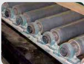
Přehřáté ložisko dopravníku
