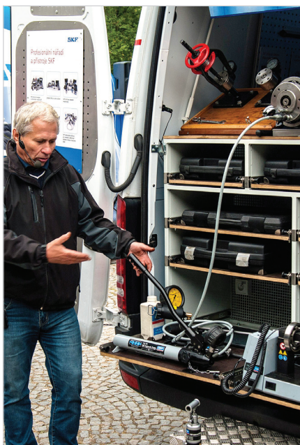
Julius Fiala představuje hydraulickou metodu SKF Drive-up, vyvinutou pro montáž soudečkových ložisek.
