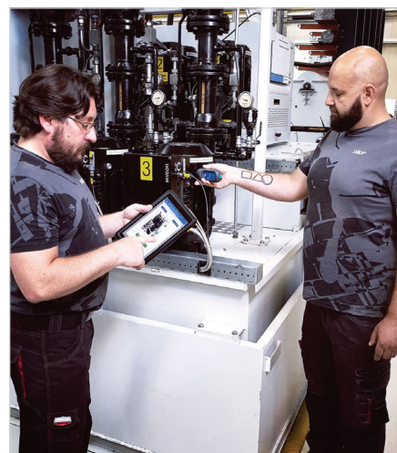
Monitorování stavu strojů v závodě SKF v Chodově zabraňuje ztrátám ve výrobě a snižuje náklady na údržbu.
