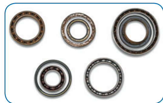
Gezeichnet vom harten Testeinsatz: Die herkömmlichen Lager, wie sie normalerweise in Mountainbikes verwendet werden.
