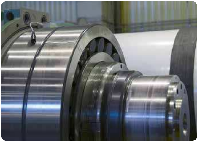
Fig. 6 De l'autre côté, le roulement à rotule sur rouleaux est également équipé pour un montage avec SensorMount.
