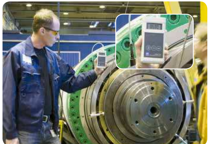
Fig. 5 0,50 : le serrage requis est atteint et la pompe hydropneumatique est arrêtée.
