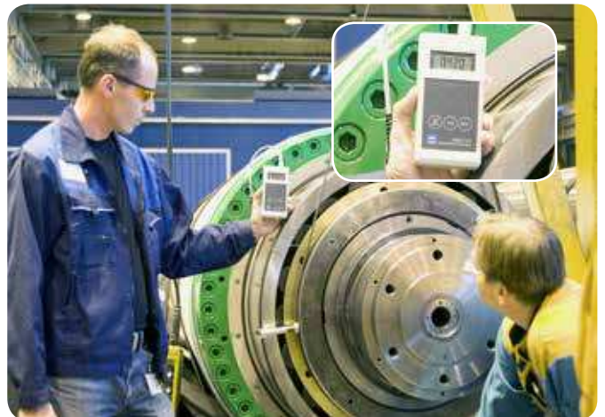
Fig. 4 L'appareil portable indique 0,420 et le technicien de Metso se prépare à arrêter la pompe hydropneumatique SKF THAP raccordée à l'écrou hydraulique HMV.
