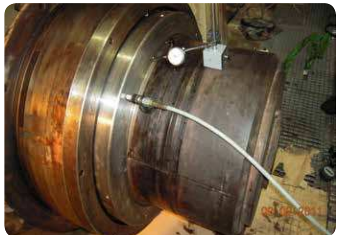
Fig. 1. Déplacement axial du manchon de serrage.
