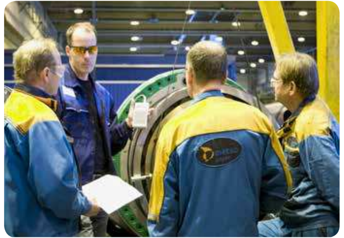
Fig. 3 Eerikki Makinen, Responsable des applications techniques chez SKF Finlande, en pleine démonstration de la procédure de montage des roulements à rouleaux toroïdaux CARB avec SensorMount.
