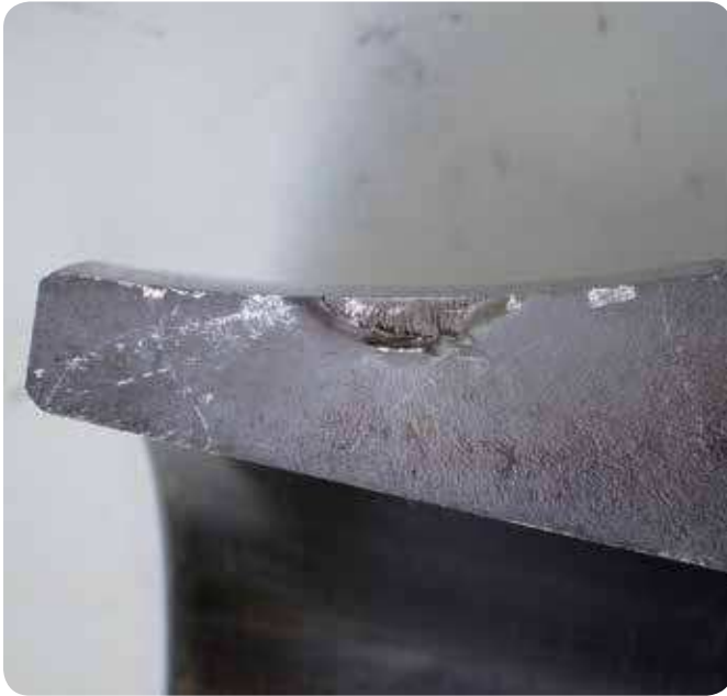
Bague intérieure de roulement à rotule sur rouleaux fendue au démarrage d'une machine à papier. Dégradation due à un écaillage profond et à un serrage beaucoup trop important.
