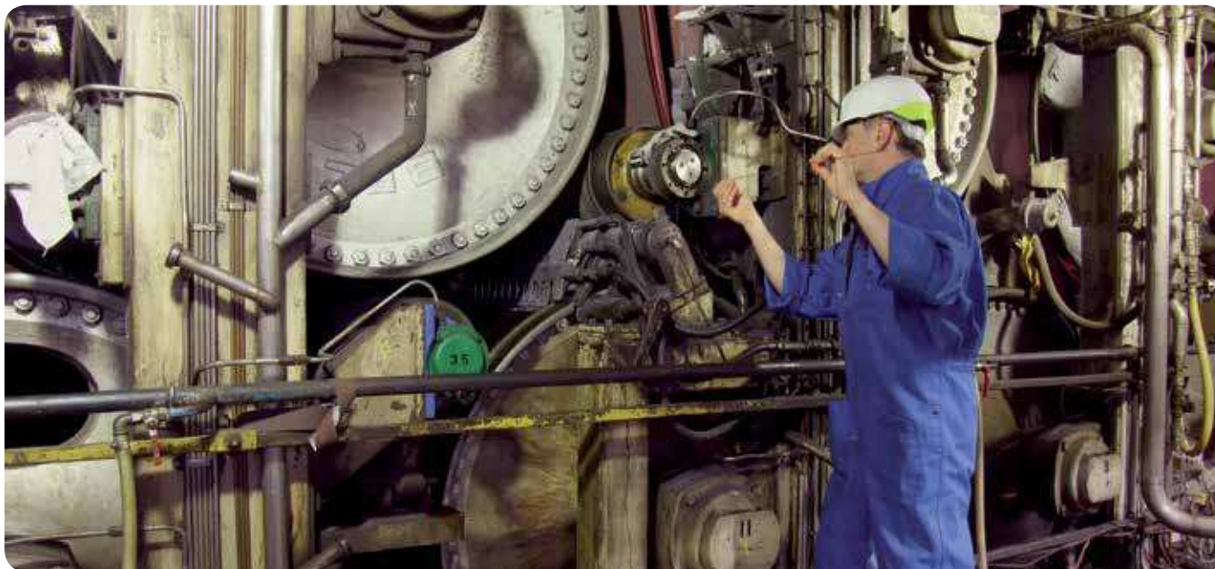
Philippe Gachet vérifiant l'état des pistes à l'aide d'un fil sur un roulement pour rouleaux de feutre.
