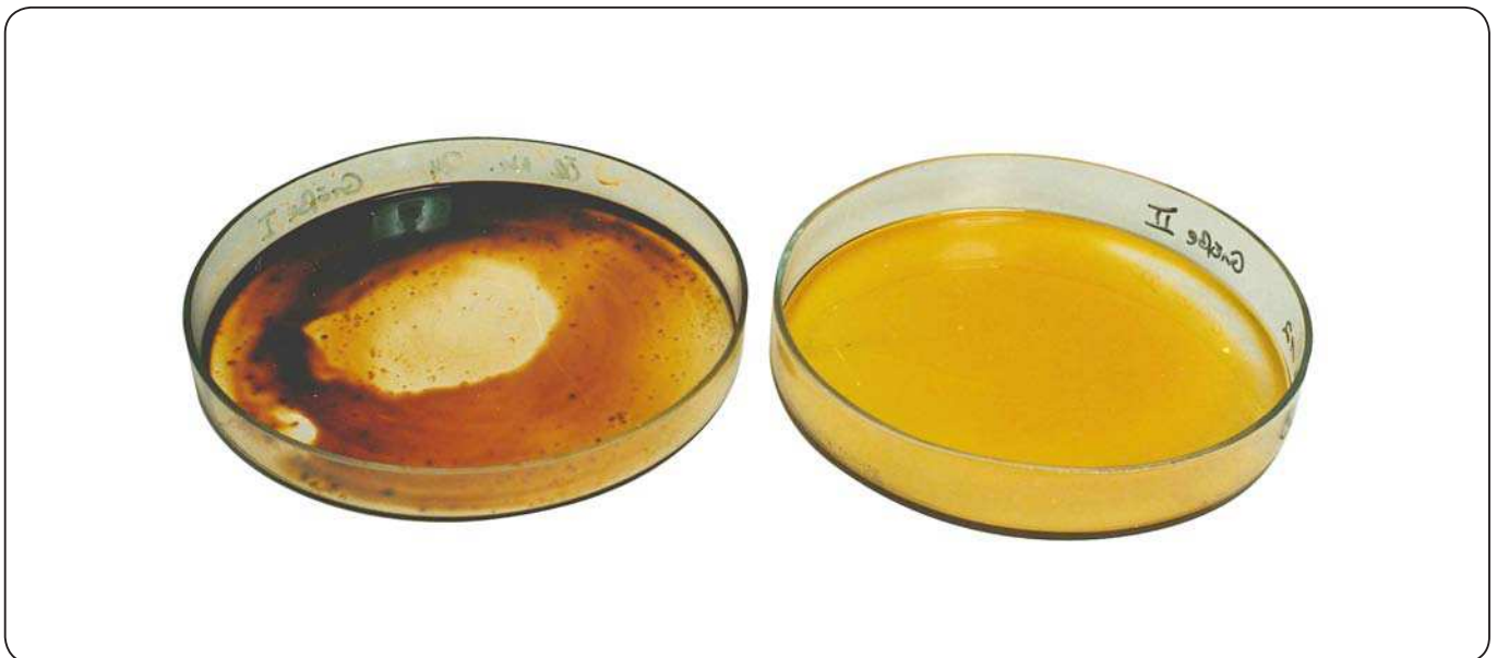
Fig. 8 Ensayo de envejecimiento de aceite SKF. A la izquierda, se muestra aceite sintético después de 4 semanas a 140 °C (284 °F), se ha laqueado y la pérdida de evaporación es 93%. A la derecha se muestra aceite mineral después de 4 semanas a 120 °C (248 °F) con una pérdida de evaporación de solo 2%.
