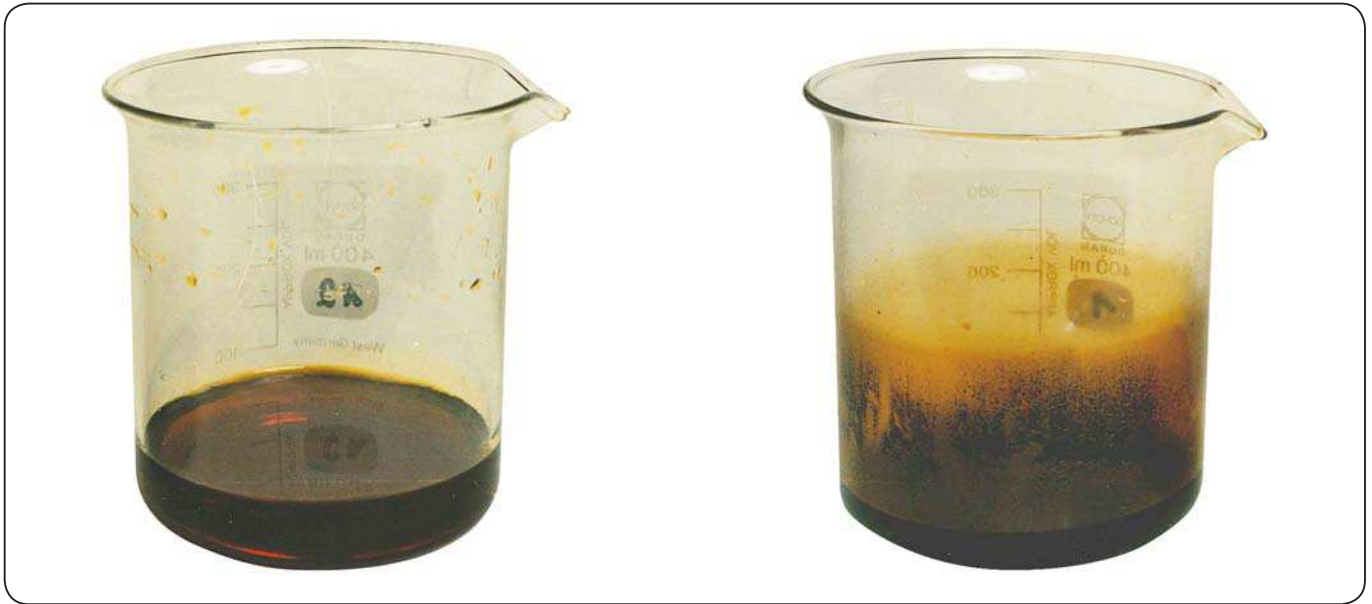
Fig. 7 Dos aceites minerales distintos después de 8 semanas a 120 °C (248 °F). El aceite de la izquierda es adecuado, en tanto el de la derecha no lo es.
