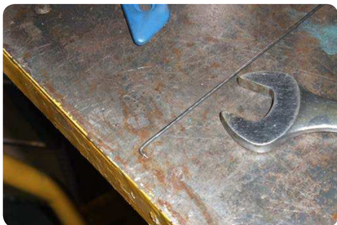
Fig. 1 Alambre doblado con una punta. Puede verse utilizando esta herramienta en la portada de la edición 2 de Prácticas SKF para Celulosa y Papel.
