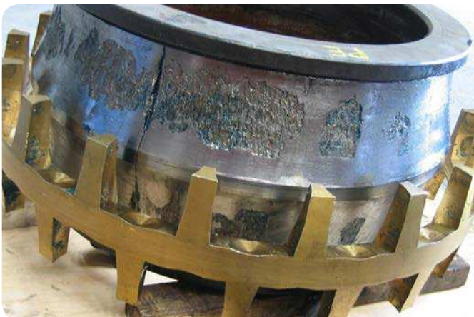
Fig. 5 El importante descascarillado significa que este aro debe descartarse.
