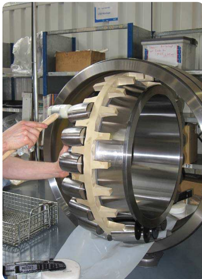
Fig. 12 Durante el montaje, se procede con especial cuidado para asegurar que los rodillos no marquen el camino de rodadura.
