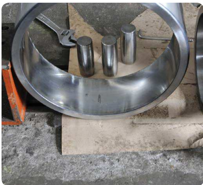
Fig. 8 Rodamiento de rodillos toroidales CARB desmontado en una fábrica papelerera listo para la inspección antes de ser enviado para su reacondicionamiento.
