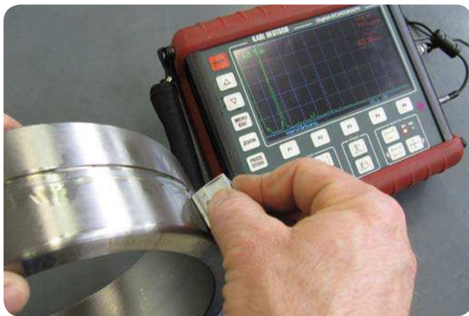
Fig. 3 Prueba con ultrasonidos para detectar microgrietas debajo de la superficie en el aro exterior de un rodamiento de rodillos a rótula.
