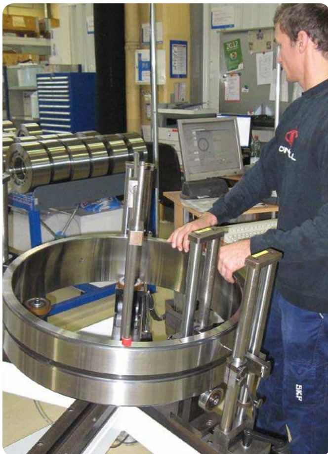
Fig. 11 Medición de la variación del espesor de la pared y la ovalidad del aro.
