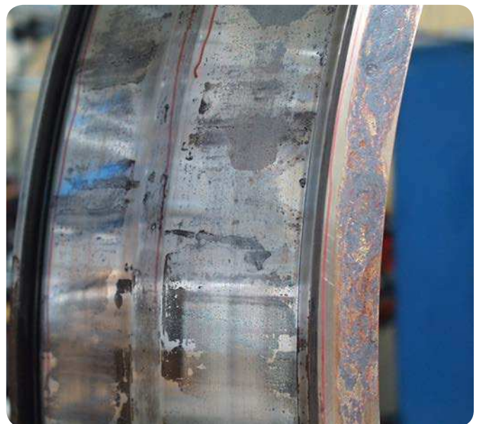
Fig. 6 El aro interior corroído de un rodillo de compensación de la deflexión.
