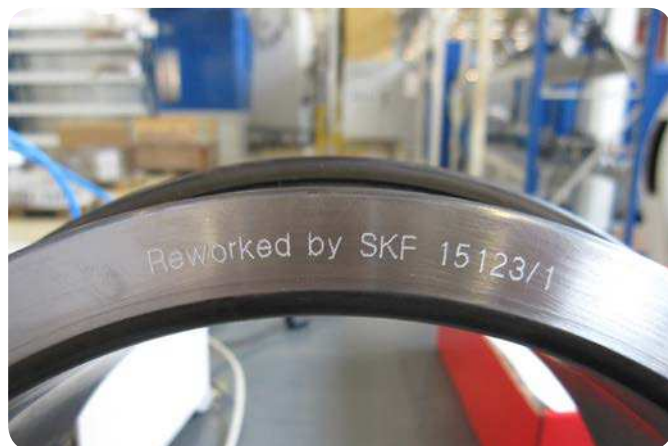
Fig. 4 Número de trazabilidad que indica el centro de la nueva zona de carga. Aquí está marcado en el aro interior del rodamiento ya que es para un rodillo de compensación de la deflexión donde el aro exterior gira con el cilindro.
