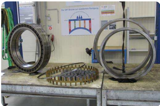
Fig. 9 Desmontaje de un rodamiento en un centro de reacondicionamiento de SKF.
