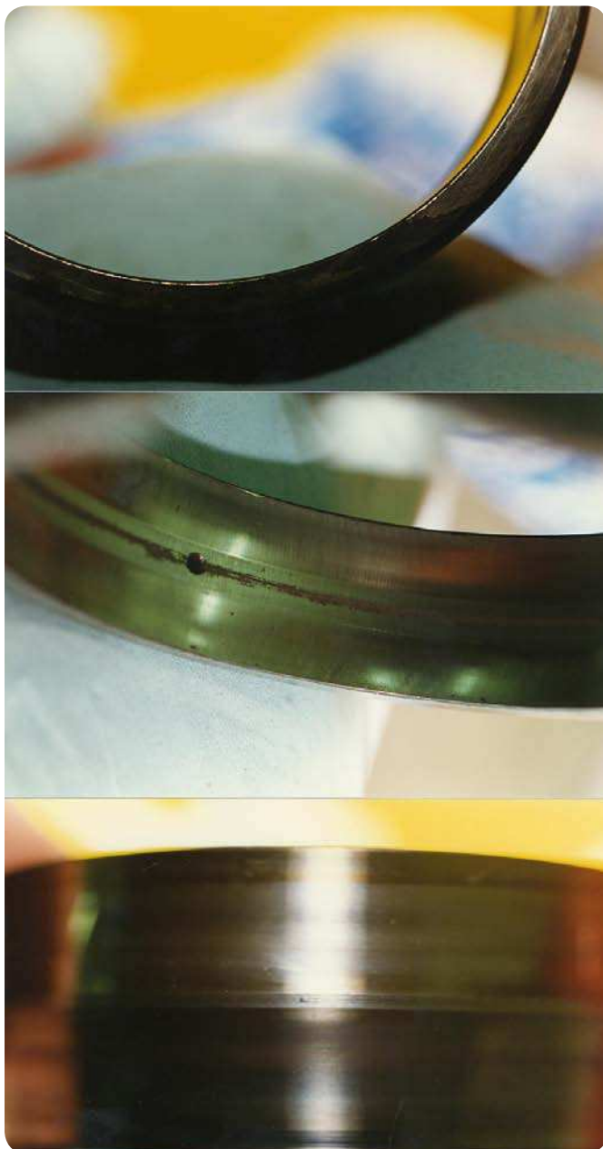
Fig. 13 Rodamiento Solid Oil después de 8 meses de funcionamiento en un rodillo de fieltro con agua en el soporte. En la fotografía superior se puede observar el nivel de agua en el soporte, debido a la corrosión en la cara lateral del aro exterior.
