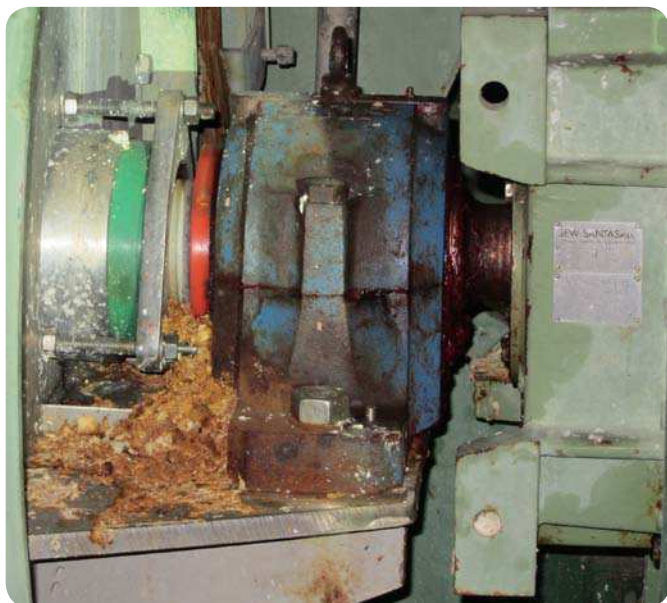
Fig. 6 Fibra que se fuga del sello de prensaestopas de una lavadora de pasta. Nótese la protección adicional frente al soporte, para proteger al sello del soporte.
