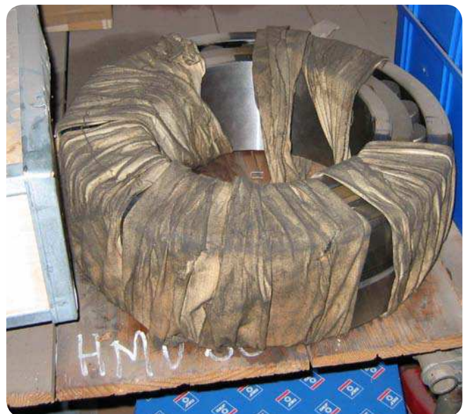
Fig. 5 Rodamiento guardado sin protección contra el polvo.
