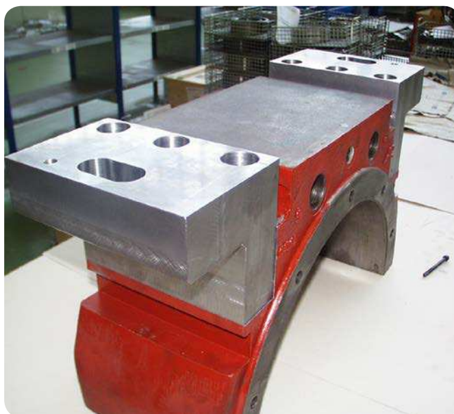
Fig. 5 La base del soporte se mecaniza para retirar los balancines y aceptar pies adaptados. También se modifica la entrada y la salida de aceite.
