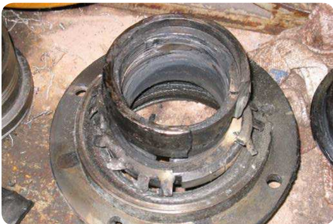
Fig. 12 Desgaste avanzado con giro del manguito de fijación en el eje de un rodamiento de rodillos de fieltro de la sección de secado. La alta temperatura asociada redujo el juego del rodamiento, lo que dio como resultado una precarga descontrolada y, finalmente, agarrotamiento.
