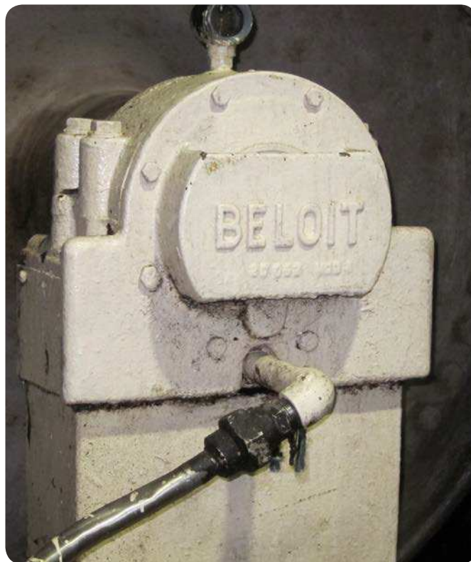
Fig. 4 Un soporte de balancín en una antigua máquina papelerera.
