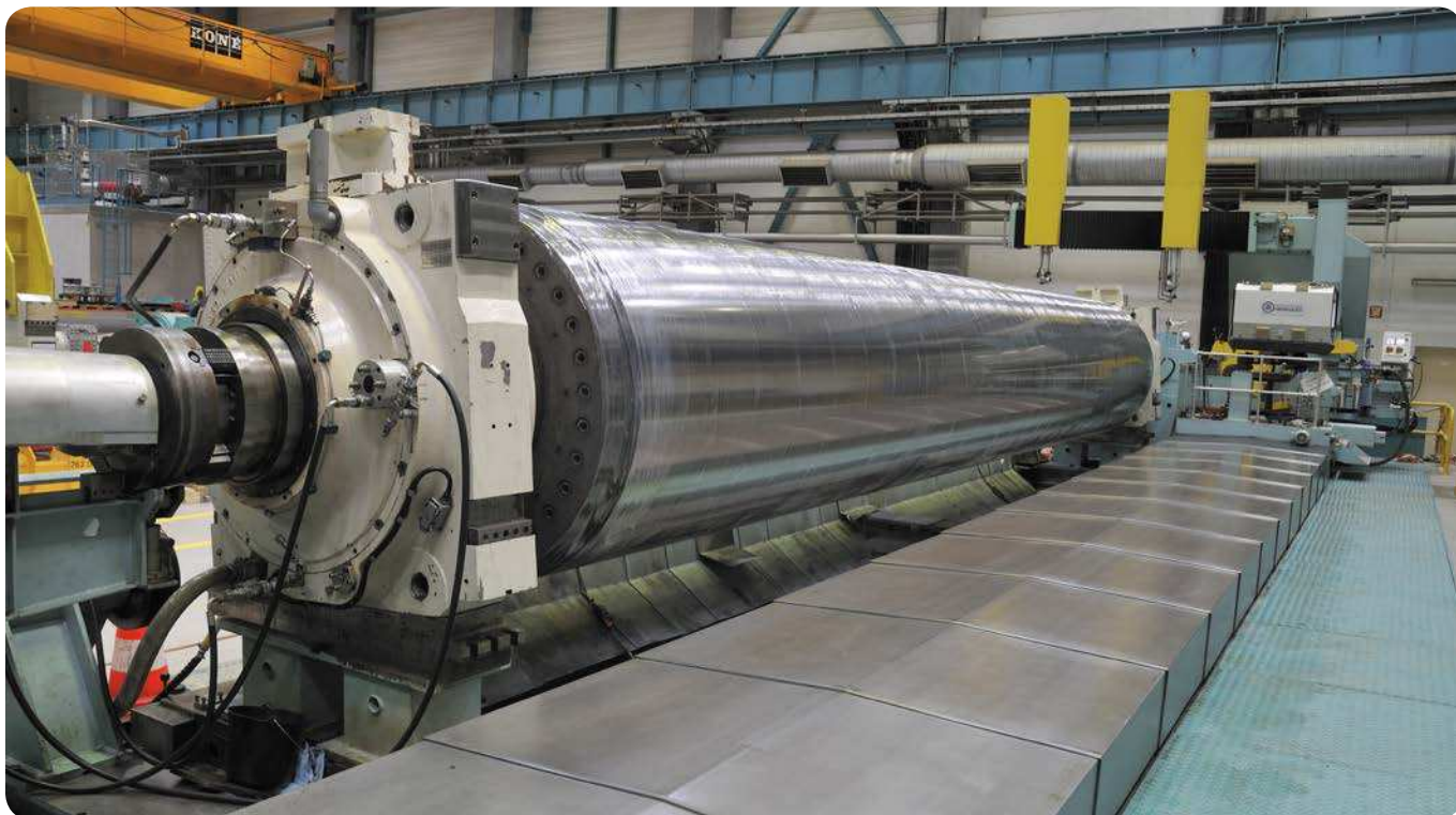
Fig. 7 Una máquina de rectificado de rodillos con el rodillo girando sobre sus rodamientos principales.
