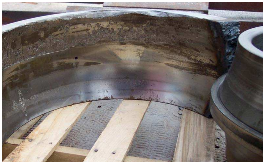
Fig. 7: Rodadura externa del rodamiento gravemente dañada
