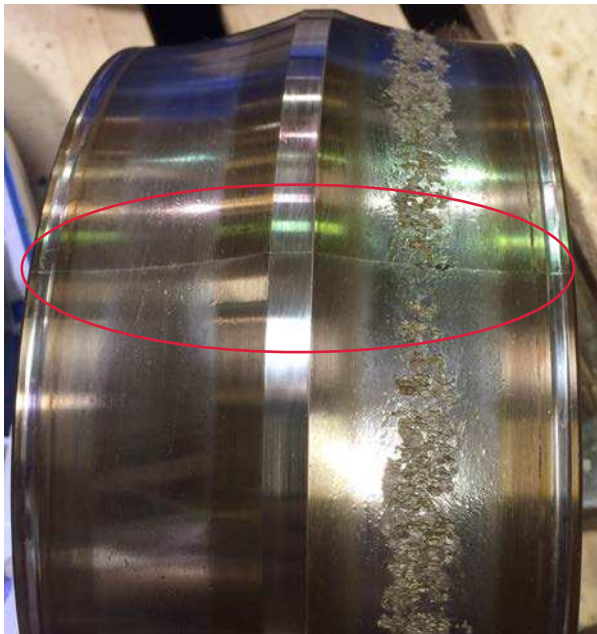
Fig. 16: Aros interior y exterior en rodamiento dañado
