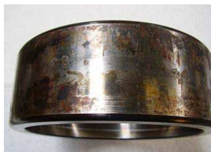
Fig. 4: Corrosión por contacto en aro exterior
