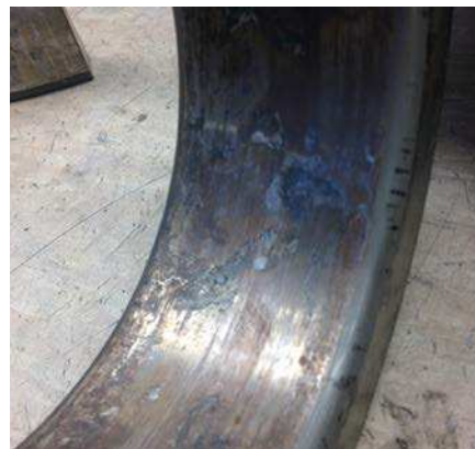
Fig. 8: Evidencia de deslizamiento de aro sobre aro interior del rodamiento
