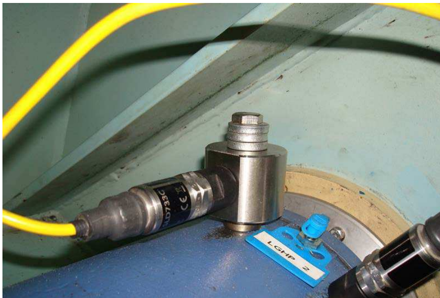
Fig. 11: Colocación de sensor radial
