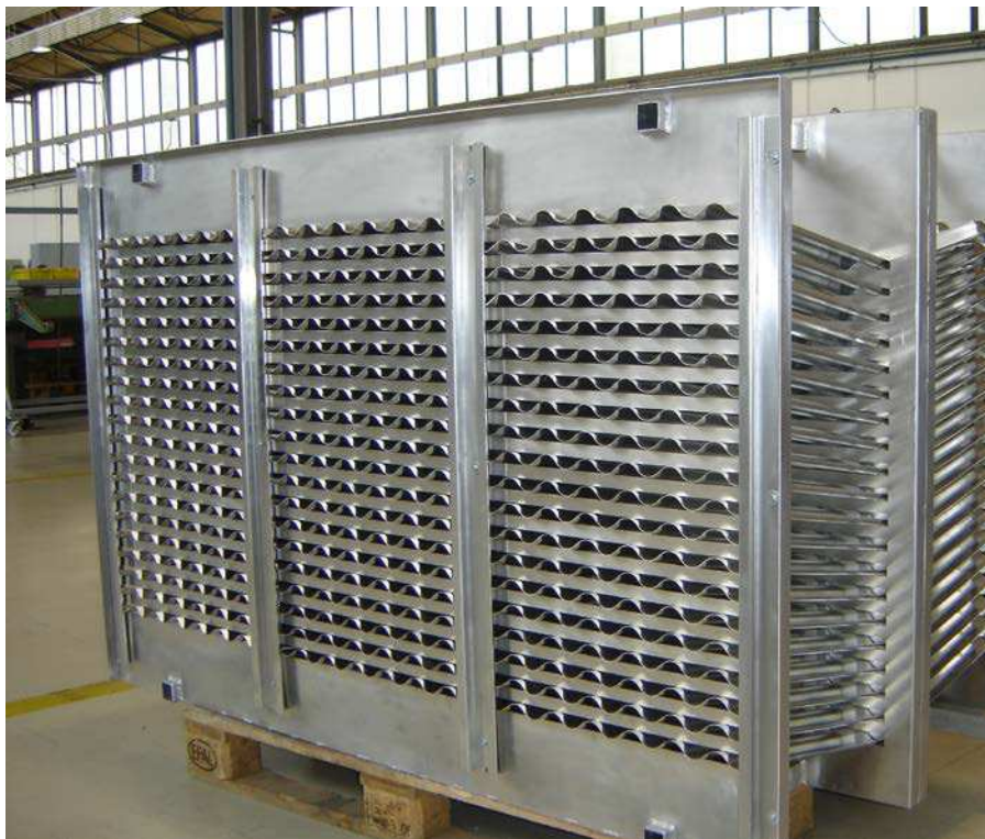
Fig. 3: Ejemplo de separadores de placa internos hallados en algunos depósitos de aceite nuevos de SKF para mejorar la remoción de agua y aire
