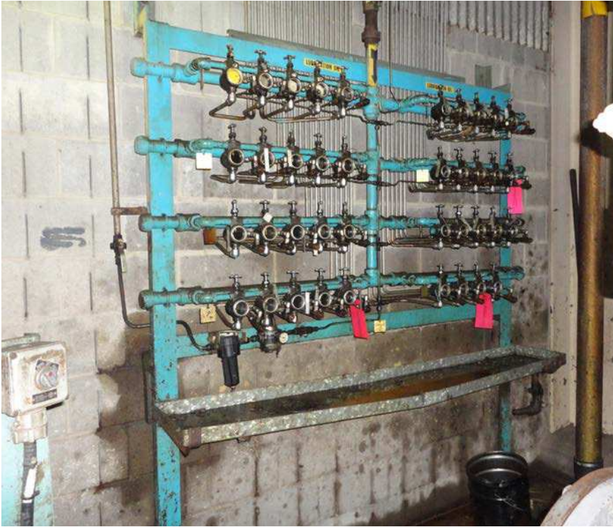
Fig. 2: Antiguos indicadores visuales para monitorear el flujo de aceite en máquinas más antiguas. Algunas veces encontrados aún durante las auditorías, suelen tener pérdidas grandes, por eso la bandeja colectora. En la actualidad, SKF cuenta con tecnología mucho mejor para monitoreo de flujo, alarmas y tendencias.
