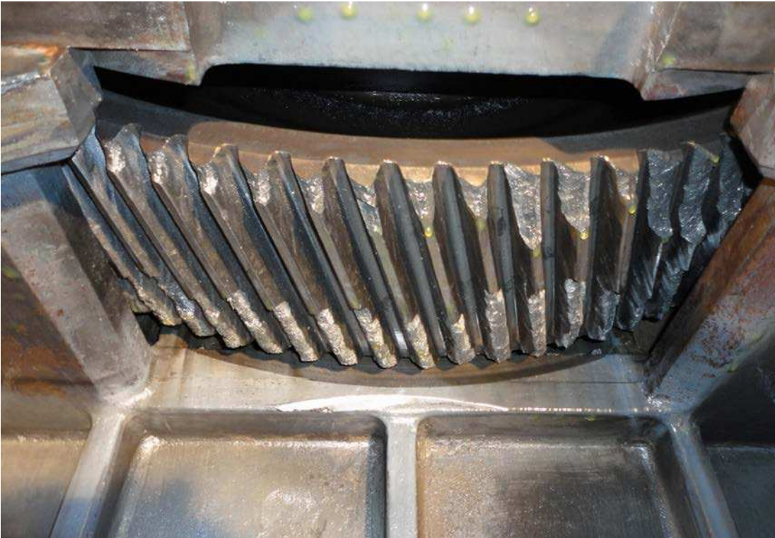
Fig. 1: Desgaste grave en los dientes del engranaje
